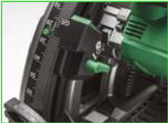
Doppia scala di regolazione della profondità di taglio (con o senza guida).
